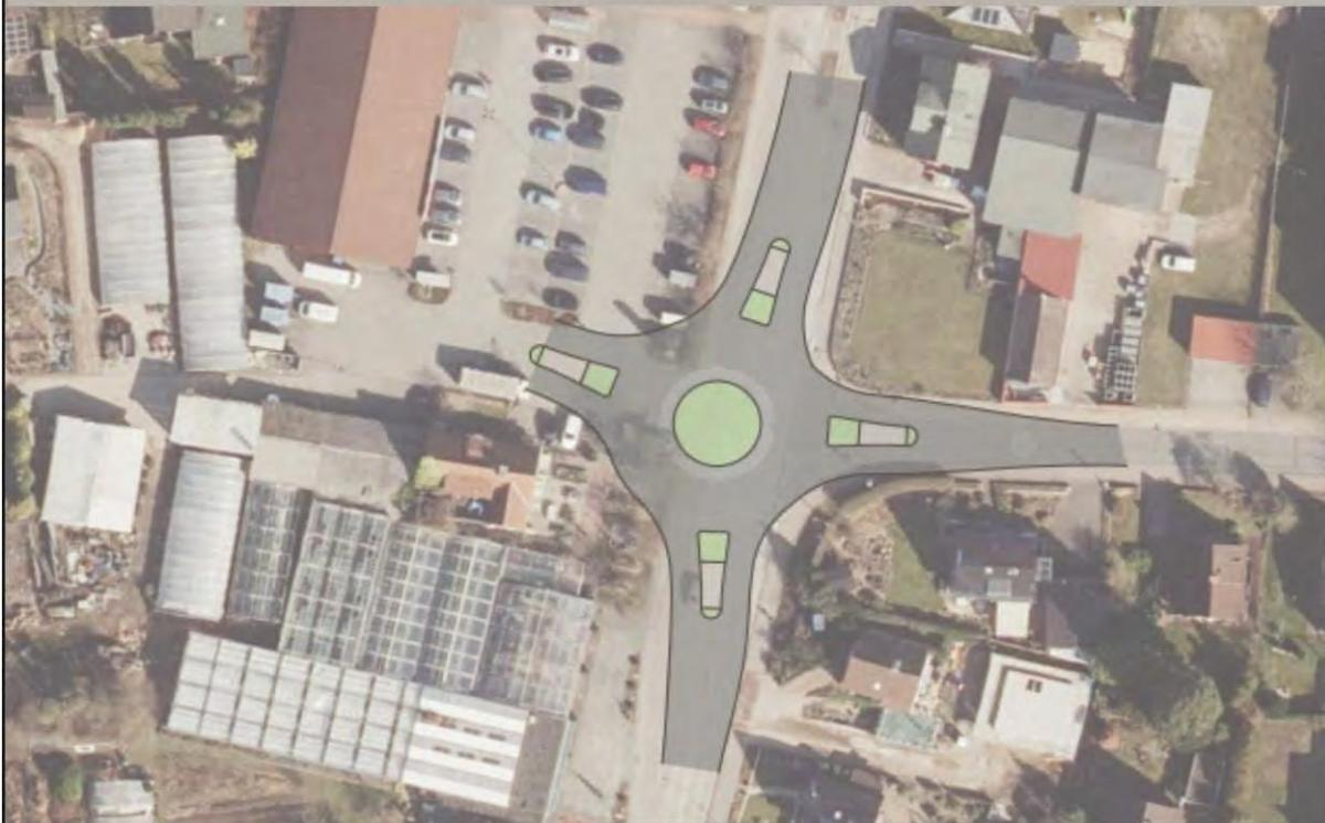
Bild 5-20: Musterlösungen für innerörtliche Kreisverkehre und beispielhafte Planungsskizze für Preetz
